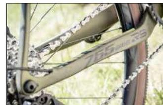
La base arrière droite permet à la chaîne d'éviter les claquements.
